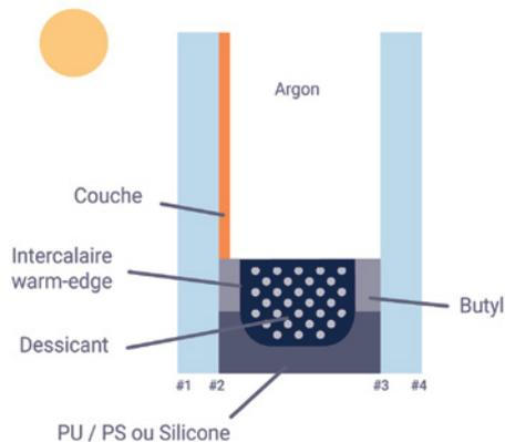
Le vitrage SprimoLight 70/37 garantit non seulement une protection solaire optimale mais offre également une excellente isolation thermique. Le SprimoLight 70/37 associe donc les performances solaires et un coefficient  $U_g$  de  $1.0 \text{ w/m}^2\text{k}$ , ce qui le rend très efficace.
